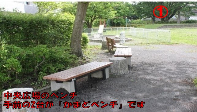
災害時には 座席を外して、金網をセットします
